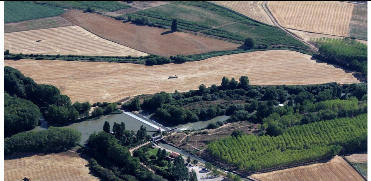
Foto aérea de Ricardo Melgar (Panoramio). Sensible diferencia de ancho de cauce aguas arriba de la presa. Aguas abajo se minimiza longitud y por tanto conjunto de impactos
